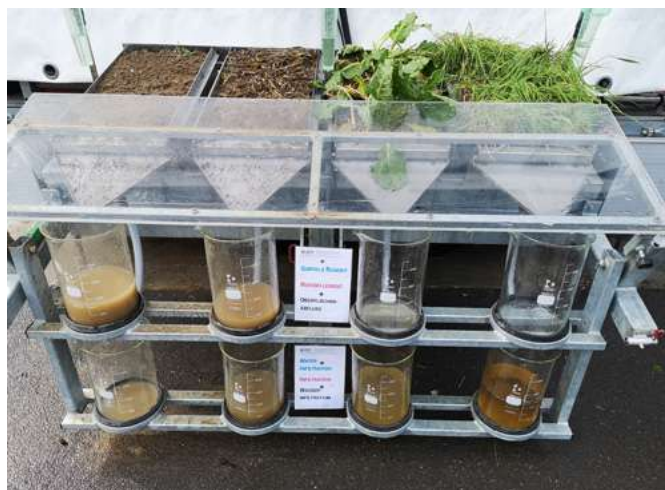
Abb. 9: Regensimulation auf Boden: ohne Bedeckung, mit Strohmulch, Rüben in Strohmulch und Wiese
