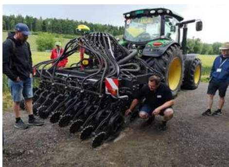
Abb. 5: Angepasste Direktsaattechnik im Dreipunkt mit Einzelschar-Druckregelsystem und Front-Saatguttank
