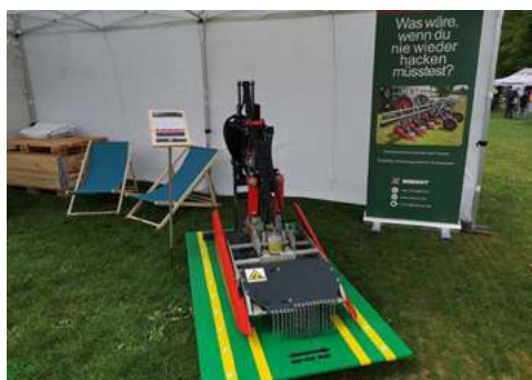
Abb. 7: Zwischenreihenmulchgerät als Alternative zum Hacken
