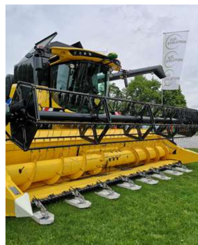
Abb. 6: Schneidwerk mit Umbau zum Soja niederdrücken beim Streifenanbau (Relay cropping) mit Winterweizen
