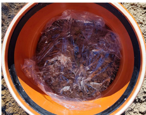
Abb. 2: Bodenoberfläche im KG-Rohr beim Wässern mit Folie bedeckt, um Splash-Erosion zu verhindern
