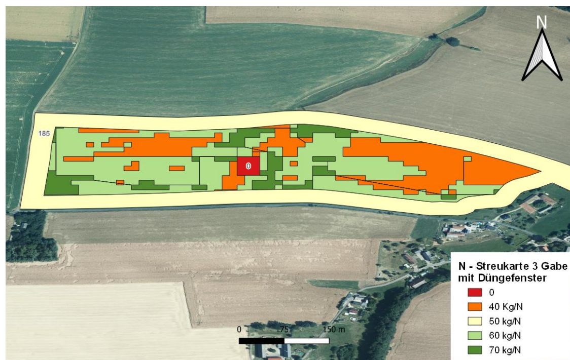
Abbildung 6: Streukarte für Spätdüngung (EC 39) auf einem heterogenen Ackerschlag nach Ertragspotential (an Hand mehrjähriger Abreifebilder)
