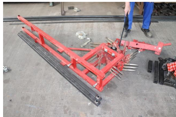
Abbildung 3: Rollspurlockerer für den Hackeinsatz (Quelle: AgUmenda)
